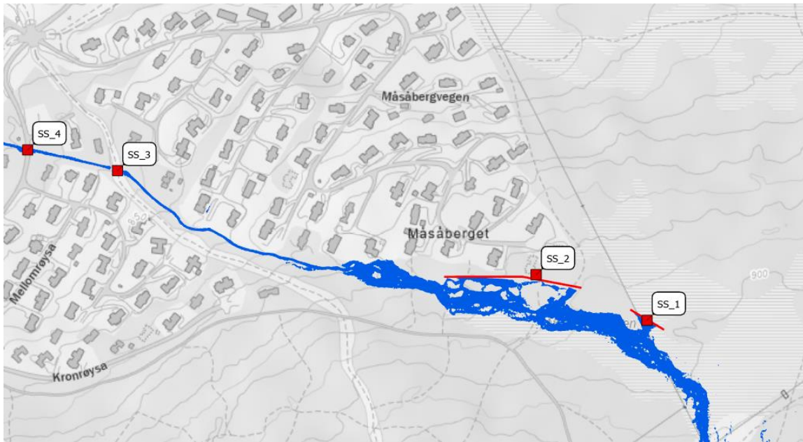
Figur 6-2: Flomsone inkludert tiltak for øvre deler av Søre Slåbekken. Røde streker indikerer voller
