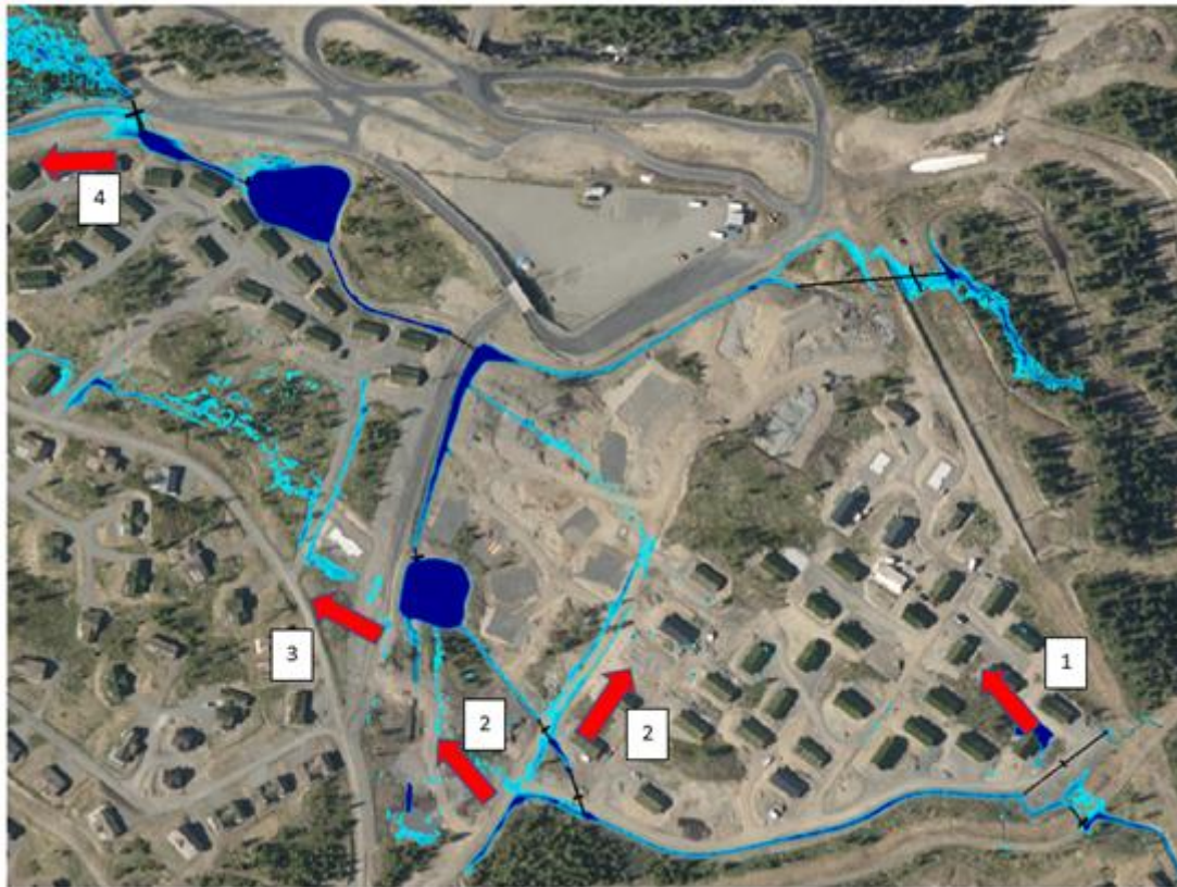
Figur 5-1: Beregningsresultater for eksisterende situasjon i Nørdre Slåbekken ved dimensjonerende flomstørrelse
