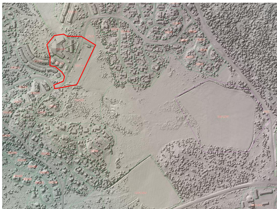
Figur 6 Tidligere inngrep i myr kommer fram som grøfter rundt oppdyrket areal i øst og i sør. Fra høydedata.no
