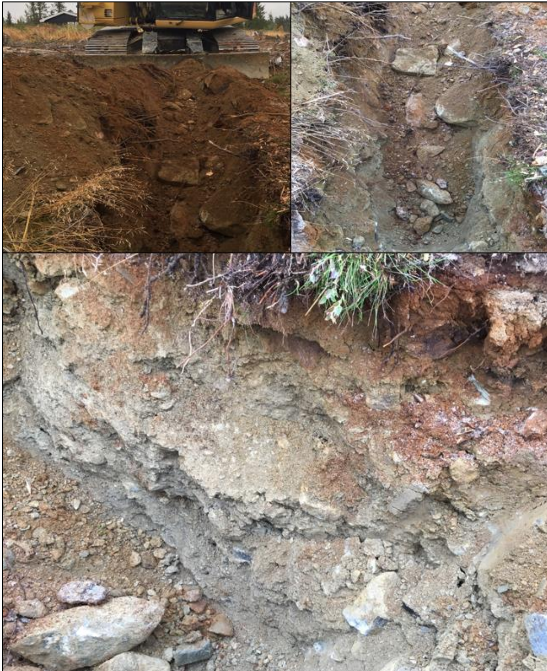
Figur 22: Sjakting og uttak av masseprøve i området markert i Figur 20.
