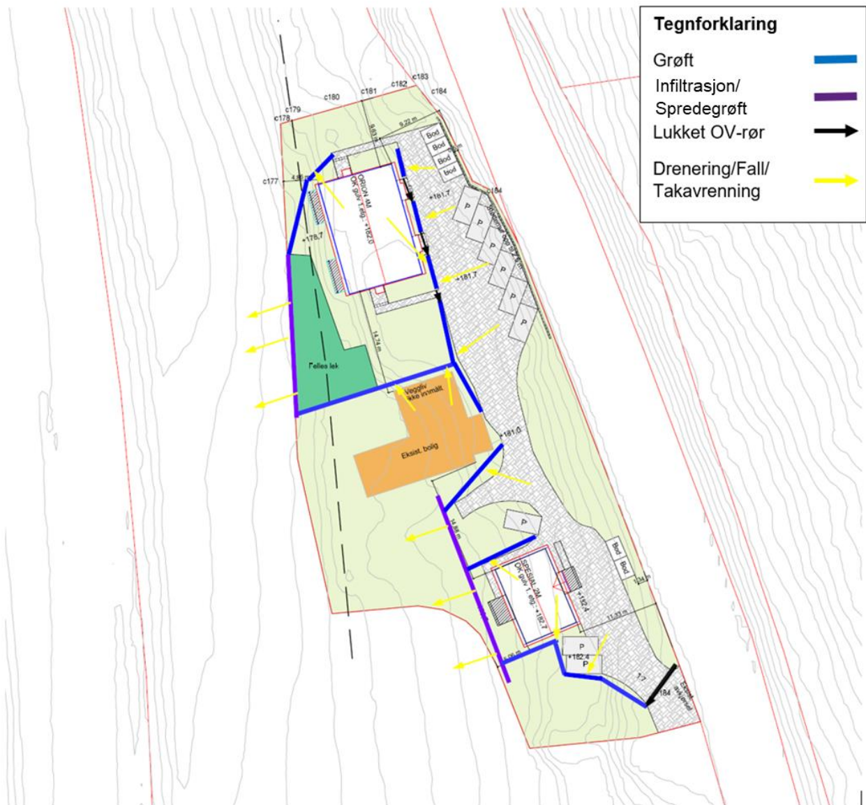
Figur 17: Situasjonsplan vist med prinsipper for overvannstiltak.
