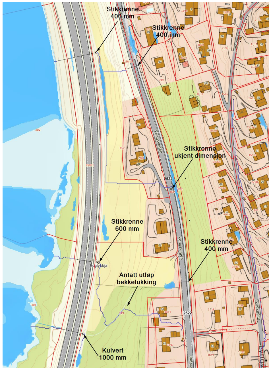
Figur 9: Flomveier og lukkinger i området. Flomveier over (>1ha) beregnet i Scalgo er vist med blå linjer. Areal med fare for oppstuvning av vann er vist i blått. Eiendomsgrenser er vist med røde linjer og stikkrenner registrert i Statens Vegvesens vegkart med svarte linjer.
