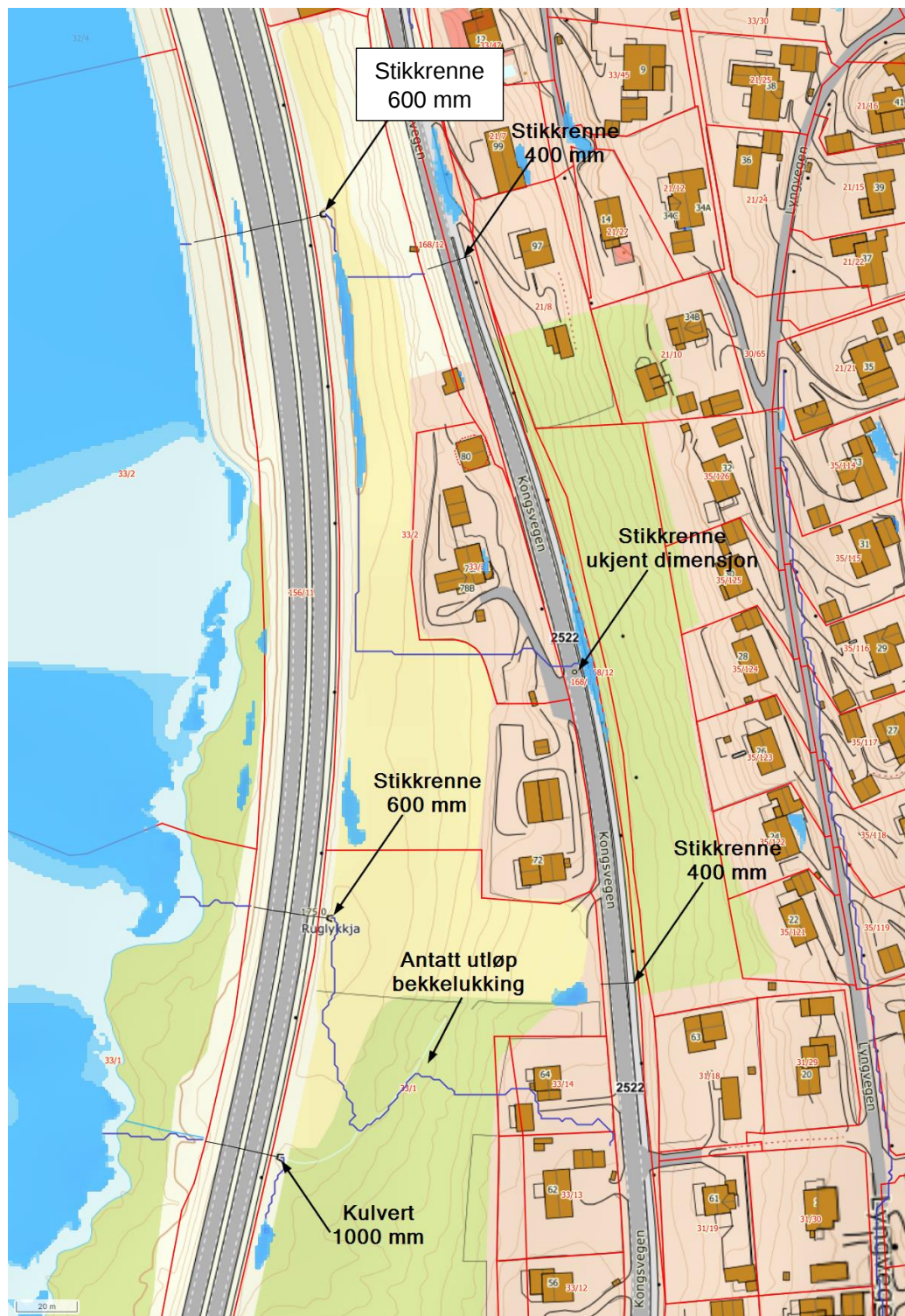
Figur 4. Flomveier og lukkinger i området. Flomveier over (>1ha) beregnet i Scalgo er vist med blå linjer. Areal med fare for oppstuvning av vann er vist i blått. Eiendomsgrenser er vist med røde linjer og stikkrenner registrert i Statens Vegvesens vegkart med svarte linjer.
