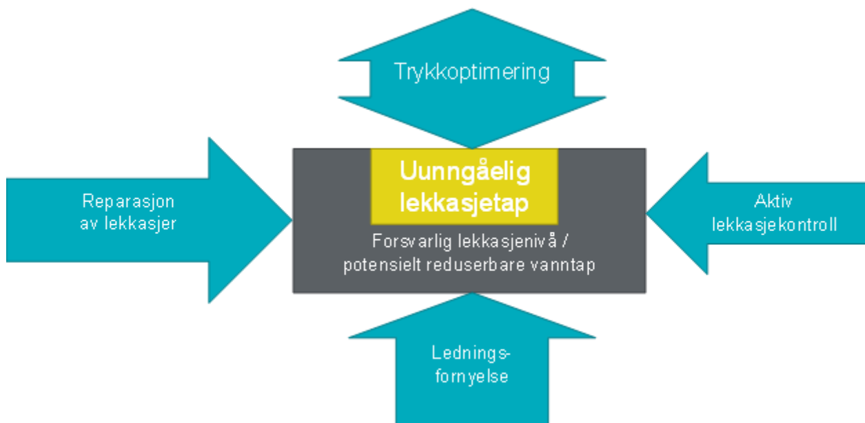
Figur 6-10 - Generelle aktiviteter for å oppnå og beholde tilfredsstillende lekkasjenivå (basert på referanse (43))
