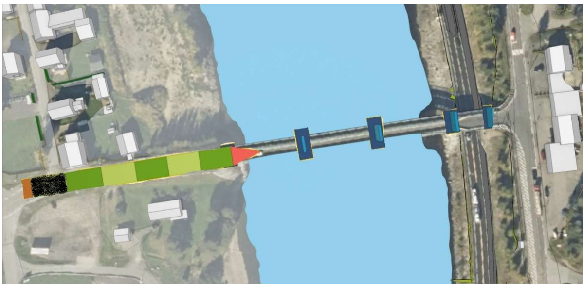
Figur 1-16 Framføring (Lansering) alternativ 3 - Bru i dagens trase. Byggegrøp er markert i svart, ca. 3 meter under dagens terreng.
