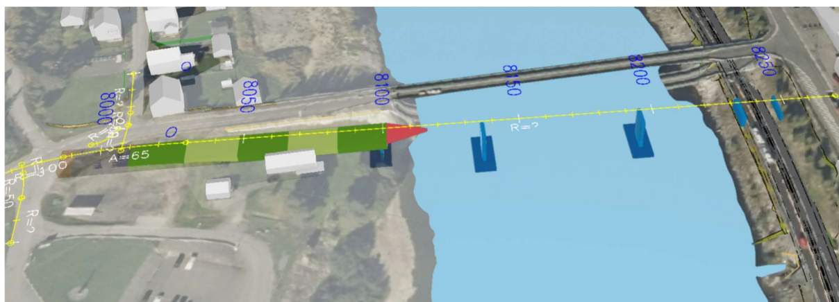
Figur 1-12 Prinsipp for framføring (lansering) av bru for alternativ 2 - Bru nedstrøms dagens bru. Byggegrøp er vist i svart markering, ca. 3,5 meter under dagens terreng.
