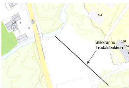
Figur 1. Stikkrenne (Ø600) Trodalsbekken.
